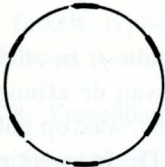
Fig. 79. Lichtspoor overeenkomende met f_1/f_2 = 6 , wanneer een cirkelvormige tijdbasis met straalmodulatie wordt toegepast.
