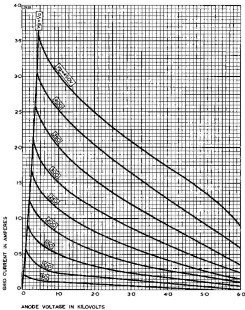
TYPICAL ANODE CURRENT — GRID VOLTAGE CHARACTERISTICS
