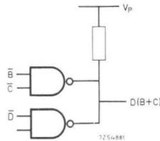
Fig. 65. 1248BCD error detector circuit.
